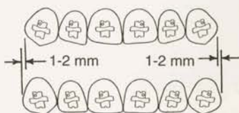
図5. 上顎6前歯が傾斜することでアーチワイヤーに沿って得られる長さ(上)は、最終的なティップの角度(下)の場合と比べて2~4mm短くなる。
