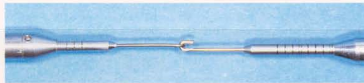
図4: リッチモンドテンションケージの4オンス計と16オンス計を相対的に反対方向に張いた状態。16オンス計(左)が4オンスを示していますが、4オンス計(右)では実際に2オンスを示しています。
